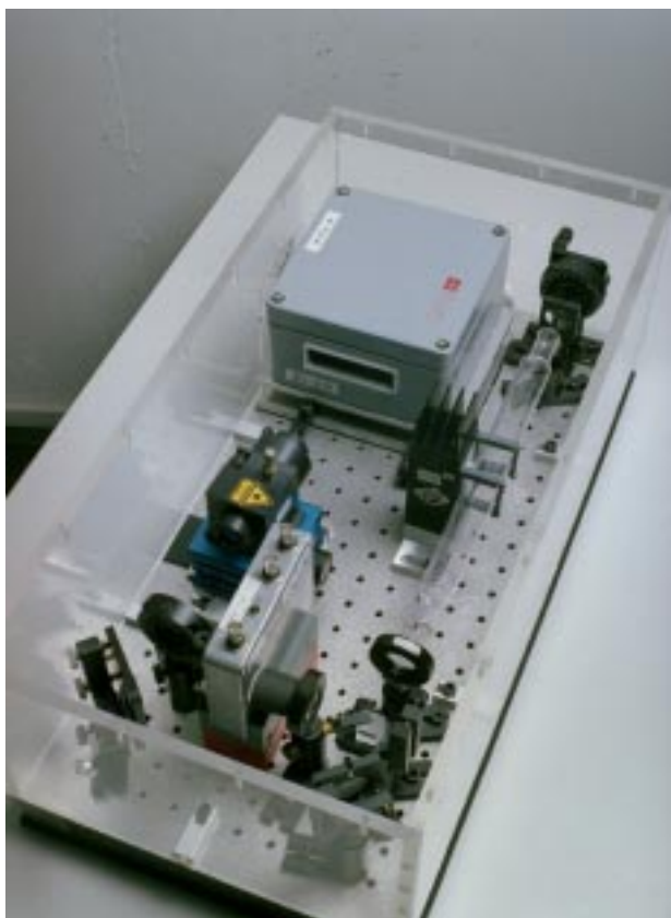
Fig. 8. Jod-stabiliseret diodelaser ved 633 nm.
